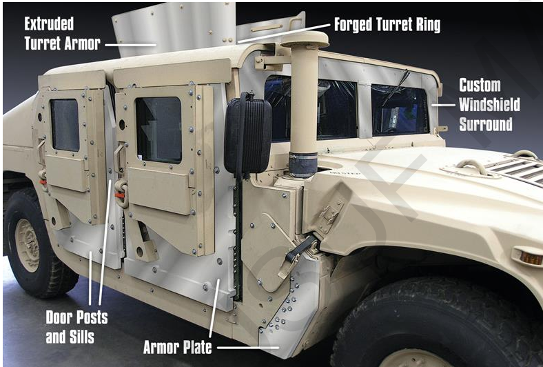
2519 Zırh plakası olarak kullanılan kısımlar (Kaiser Aluminum | STRUCTURES)
